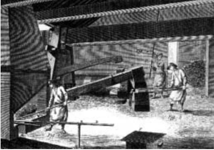
Uma forja movida por energia hidráulica (estampa extraída de “L’ Encyclopédie”, de Diderot et D’Alembert)
